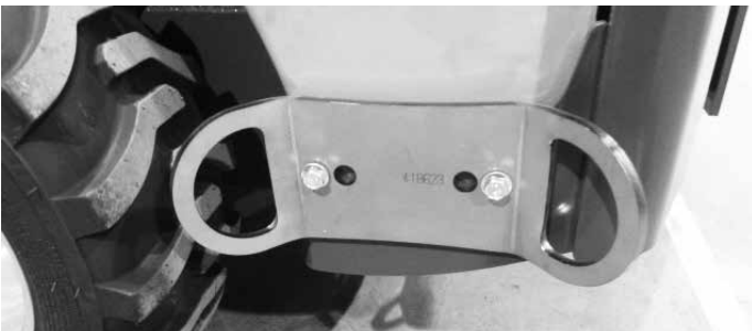
Sidontakiinnike A418623 asennettuna takarungon sivuun. Sivu-asennuksessa tarvitaan kaksi sidontakiinnikettä.
