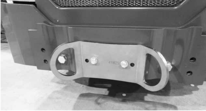
Sidontakiinnike A418623 asennettuna takapuskuriin tai takapainoon
